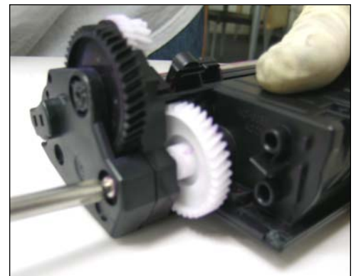
11. Para sacar los componentes del lado engranajes aflojar el primer tornillo con un desarmador phillips.
