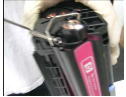
6. Utilizar un gancho para soltar el resorte del poste.
