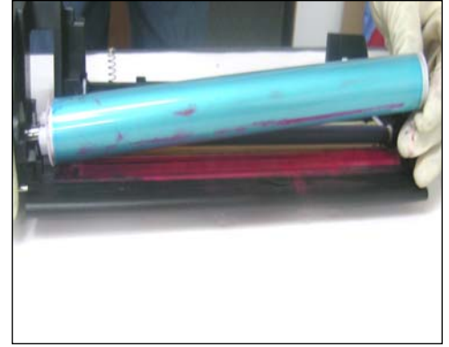
55. Incline el cilindro y eje a un ángulo de 30 grados para sacar el cilindro.
