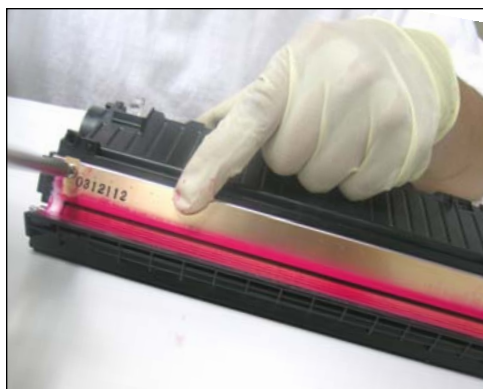
35. MONTAJE DEL CARTUCHO DE TONER: Comenzar con la re instalación de la cuchilla dosificadora.
