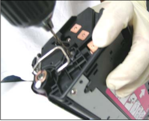
4. Repetir con el perno del otro lado del cartucho (lado sin engranajes) como se muestra.
