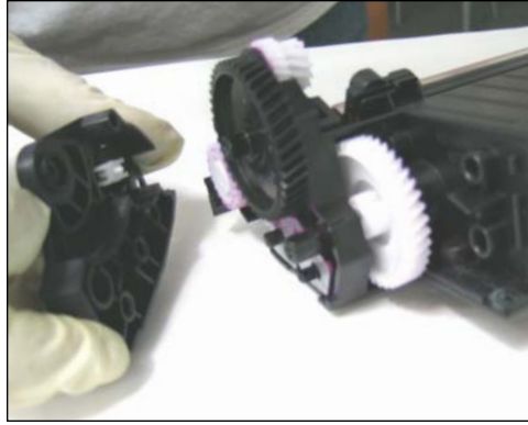
13. Retirar la tapa para mostrar los engranajes.
