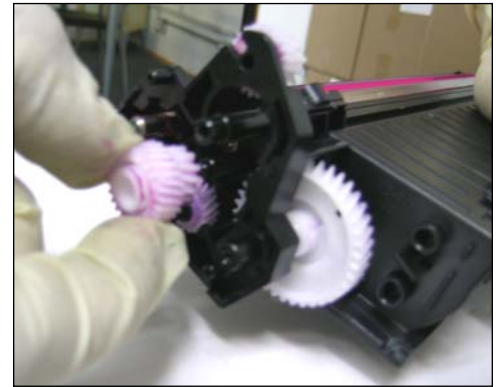
17. Retirar el primer engranaje interior.
