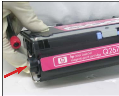
42. Es necesario ahora retirar el inserto (indicado) que sujeta el buje del eje del cilindro en su lugar.
