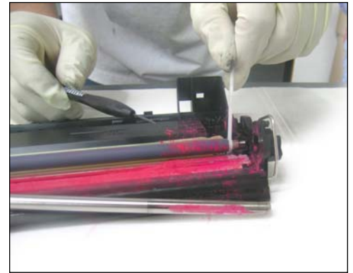
57. Sacar el Rodillo PCR destrabando ambos lados como se muestra.
