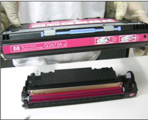
7. Separar las secciones del cilindro y toner.
