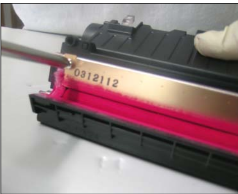
27. Preceder a sacar la cuchilla dosificadora extrayendo los dos tornillos que la sujetan.
