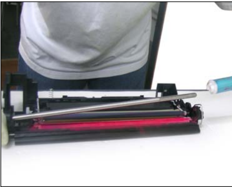
56. Deslize el cilindro como se muestra
