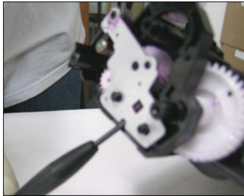
16. Sacar la placa metalica haciendo palanca con un pequeño desarmador.
