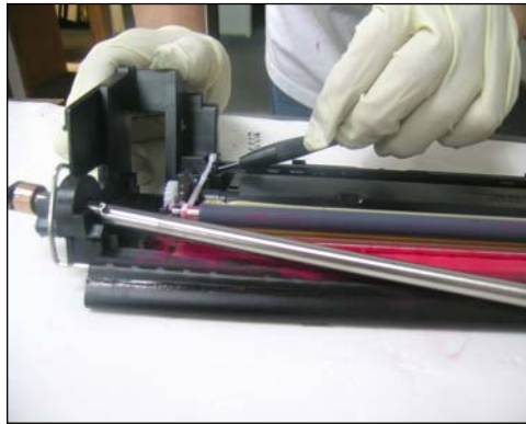
57. Sacar el Rodillo PCR destrabando ambos lados como se muestra.
