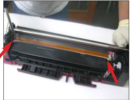
60. desmontar la cuchilla destornillando ambos lados como se muestra.
