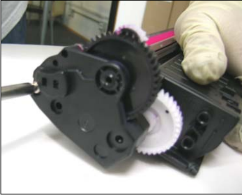
12. Sacar el segundo tornillo según se muestra.
