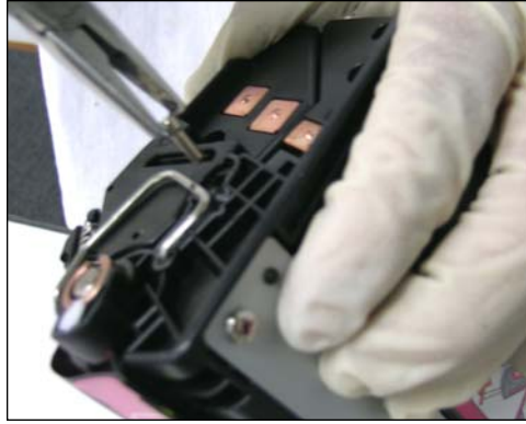
5. Extraer el perno como se muestra en la foto.
