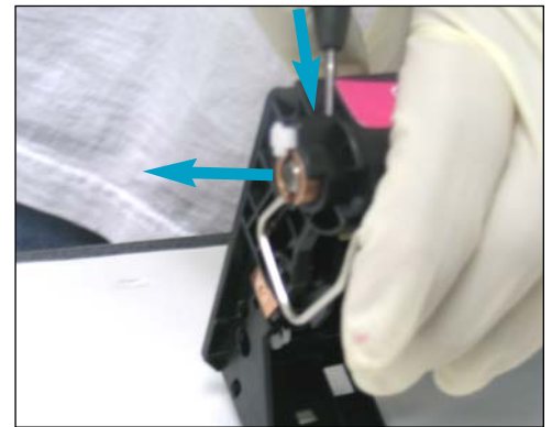
43. Inserir un desarmador plano pequeño en el agujero para empujar el inserto hacia afuera.
