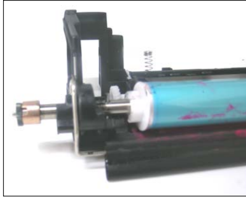
54. Deje el buje colgar del borde como se muestra.
