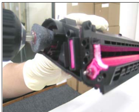
32. Usar sierra tipo copa de 25,4mm para agrandar el agujero. No entrar demasiado pues se puede dañar la ventana del sensor de toner.
