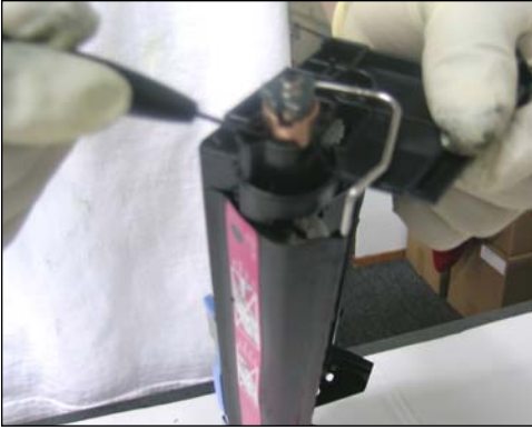
53. Forzar el buje del eje hacia afuera.
