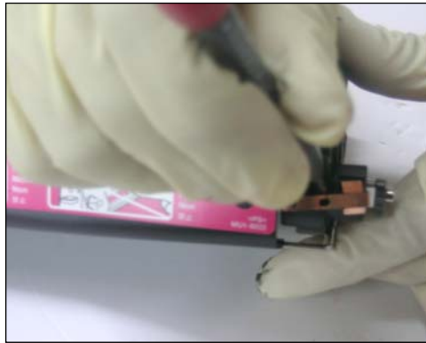
48. Insertar un pequeño desarmador en el agujero debajo del contacto y empujarlo.
